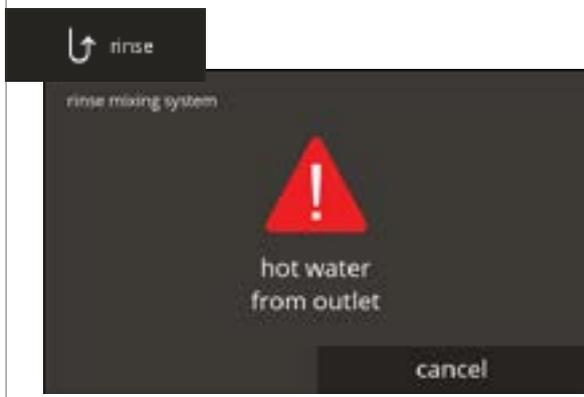
Al pulsar **■** en la pantalla de selección de bebidas durante 5 segundos, se activa inmediatamente el aclarado rápido con 90 ml (agua caliente) por sistema de mezclado.
